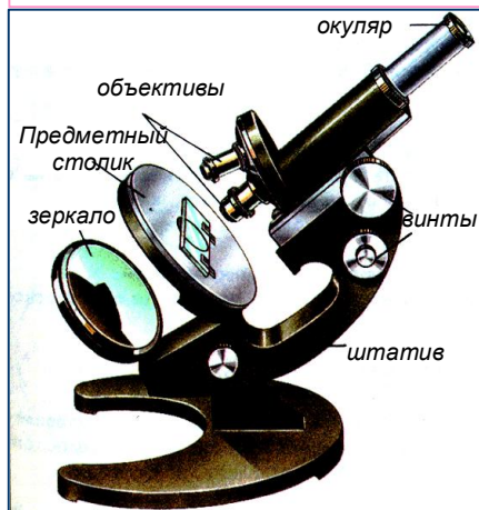
Рис. 15. Внешний вид микроскопа со сменными объективами.
