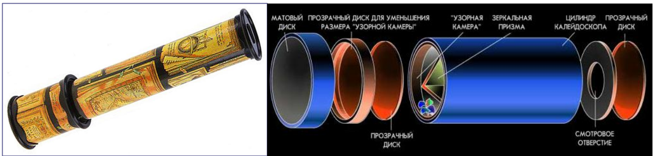
Рис. 35. Плоские зеркала, сложенные в трёхгранную зеркальную призму используются в калейдоскопе – приборе, способном создавать неповторяющиеся симметричные узоры. Внешний вид и устройство.
