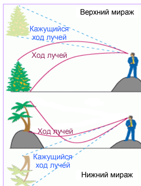
Рис. 1. Миражи возникают, когда свет распространяется в оптически неоднородной среде — в воздухе различной температуры.
