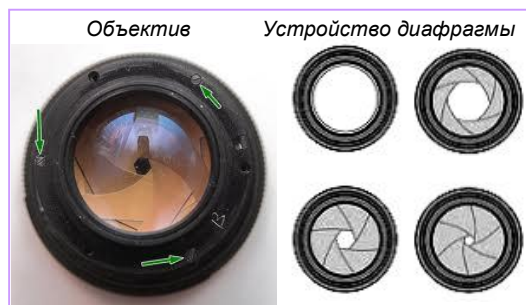
Рис. 2. Объектив с регулируемой диафрагмой. Стрелки показывают направление поворота кольца диафрагмы.
