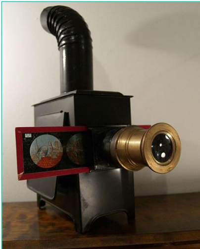
Рис. 8. Волшебный фонарь. До появления электрических ламп в таких проекторах использовались свечи и лампада. Сверху видна труба вентиляции.
