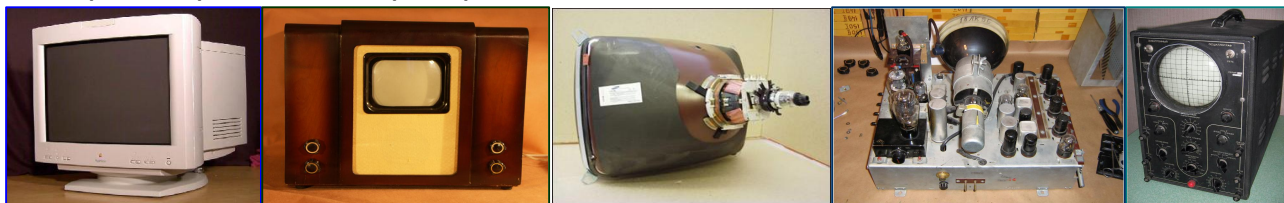
Рис. 167. Монитор компьютера 90 годов XX в; один из первых ламповых телевизоров середины XX века КВН-49; его кинескоп и внутренняя панель; осциллограф – приборы с электронно-лучевой трубкой.
