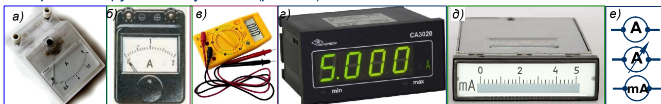
Рис. 74. Приборы для измерения силы тока. Амперметры а) школьные; б) лабораторные; в) цифровой монтажный; г) цифровой; д) миллиамперметр; е) обозначения на схемах.
