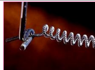
Рис. 111. Спираль лампы мощностью 200 Вт (сильно увеличено)
