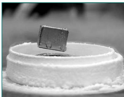
Рис. 170. Магнит висит над охлажденным жидким азотом сверхпроводником с током.
