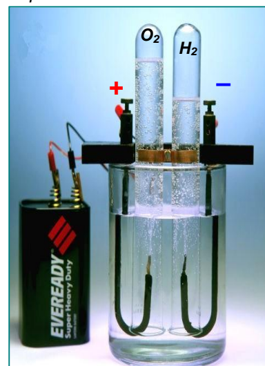
Рис. 126. Электролитическое разложение воды с добавлением 2% кислоты
