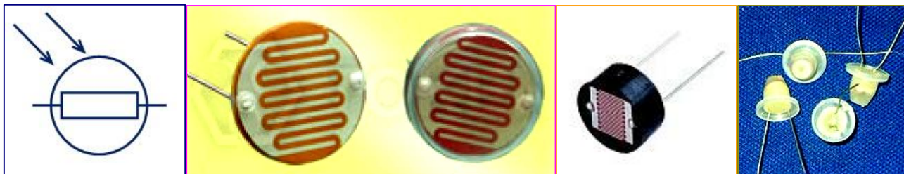
Рис. 152. Полупроводниковые фоторезисторы: изображение на схеме, внешний вид различных фоторезисторов.
