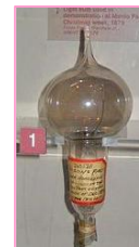
Лампа Эдисона с нитью накала из угольного волокна.
