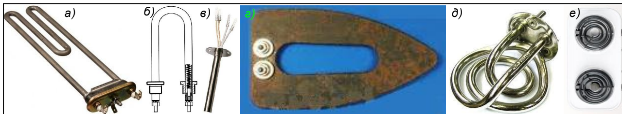
Рис. 112. Термoeлектрические нагреватели (ТЭН). ТЭН для стиральной машины: а) внешний вид и б) устройство. ТЭН в) для электропаяльника; г) для утюга; для чайника. Электроплита с открытыми термoeлектрическими элементами.
