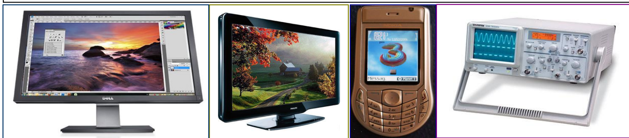
Рис. 168. Современные: монитор компьютера; телевизор, мобильный телефон; осциллограф – электронные приборы с жидкокристаллическим экраном.
