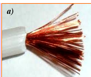
Рис. 6. Металлы медь (а) и алюминий (б) очень хорошие проводники электричества. Из таких диэлектриков, как стекло (в), фарфор (г) изготавливаются изоляторы.
