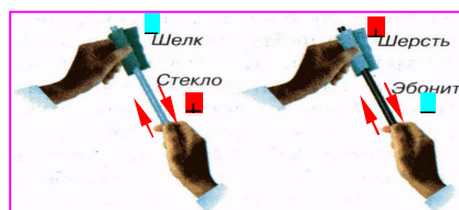
Рис. 3. В электризации всегда участвуют два тела. При трении они приобретают заряды противоположных знаков.
