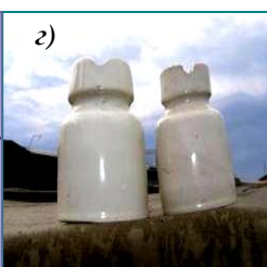
Рис. 6. Металлы медь (а) и алюминий (б) очень хорошие проводники электричества. Из таких диэлектриков, как стекло (в), фарфор (г) изготавливаются изоляторы.
