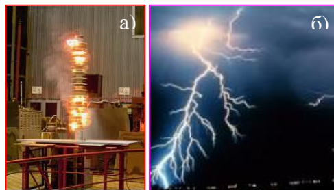
Рис. 49. Явление пробоя диэлектрика (воздуха): а) пробой при испытании высоковольтного изолятора; б) молния – пробой атмосферного воздуха.
