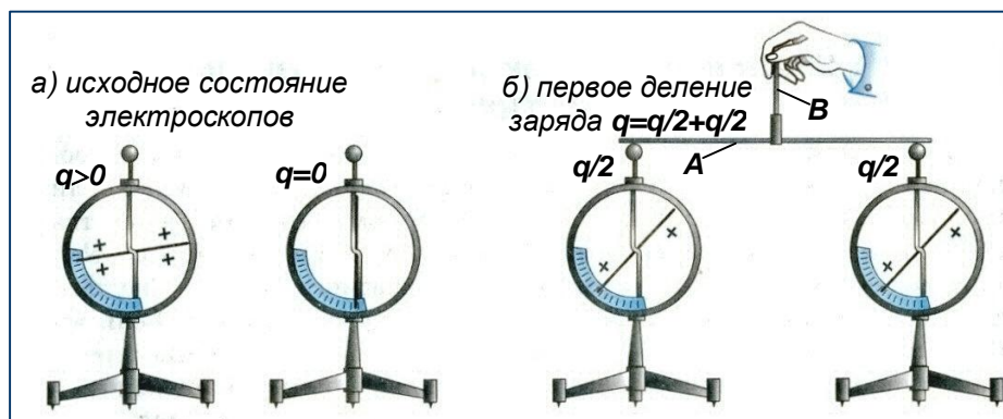
Рис. 24. К вопросу о делении заряда q . Соединяя два одинаковых электроскопа, один из которых имеет заряд q , разделим его пополам q/2 + q/2 . Разрядив второй электроскоп и повторяя подобное деление заряда q/2 , оставшегося на первом, получим q/4 + q/4 на каждом из электроскопов. Продолжая, будем получать: q/8 + q/8 ; q/16 + q/16 , и т. д.
