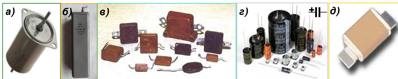
Рис. 38. Конденсаторы обычно различают по типу применяемого в них диэлектрика: бумажные (а, б), слюдяные (в), электролитические (г), керамические (д). Это конденсаторы постоянной (неизменной) ёмкости.
