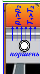
Рис. 4Д. При быстром сжатии газа в цилиндре перед поршнем давление p и температура T больше, чем в остальном объёме.
