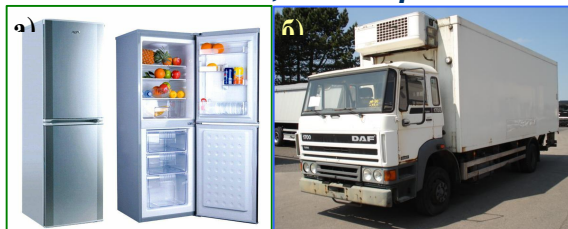
Рис. 17.3 Бытовой холодильник (а) и рефрижератор — транспортное средство с холодильной установкой для перевозки пищевых продуктов при искусственном охлаждении (б).
