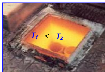
Рис. 3Д. Это тигель с расплавленным золотом. Различие цвета указывает на различие температур в различных точках тигля.
