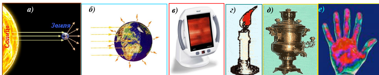
Рис. 61.1. Все тела более нагретые излучают тепло в сторону тел менее нагретых. Солнце (а) и Земля (б) в космическое пространство. Бытовой лучистый обогреватель(в) в комнату. И свеча (z). И самовар (д). И человеческое тело (этот снимок получен специальным прибором - тепловизором) (z).
