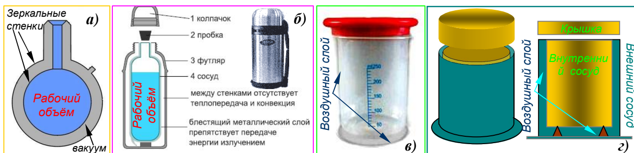
Рис. 4.2п. а) Сосуд Дьюара. б) Устройство бытового термоса. в) Лабораторный калориметр; общий вид. г) Устройство простейшего лабораторного калориметра.
