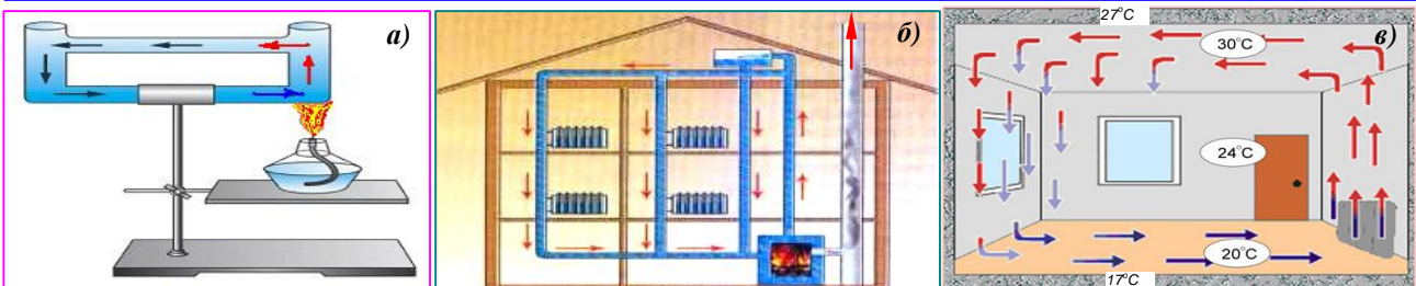
Рис. 45.1. а) Прибор для демонстрации конвекции в системе отопления; б) циркуляция воды в многоэтажном доме; в) циркуляция воздуха в отапливаемой нагретым радиатором комнате: благодаря конвекции поток теплого воздуха поднимается от радиатора вверх, а холодный опускается вниз.
