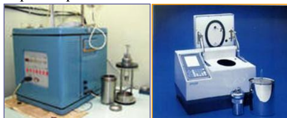
Рис. 69.1. Так выглядят современные приборы для определения удельной теплоты сгорания твердых и жидких видов топлива.
