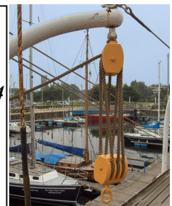
Рис. 36.4. Полиспаст для подъёма шлюпки..
