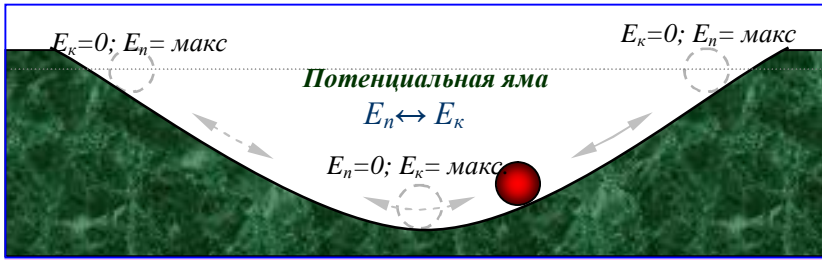
Рис. 68.4. Шарик, находясь в «потенциальной яме», совершает колебательные движения, двигаясь вправо и влево от самого нижнего положения равновесия, где E_n=0 ; E_k = \text{макс} . При движении вниз его энергия переходит из потенциальной в кинетическую: E_n \rightarrow E_k , а при движении вверх – из кинетической в потенциальную: E_k \rightarrow E_n .
