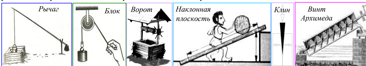
Рис. 14.4. Примеры простых механизмов, которые человек начал использовать очень давно. С их помощью созданы уникальные сооружения. Механизмы эти в усовершенствованном виде применяются и сейчас.
