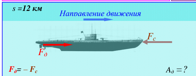
Рис. 5.4. Подводной лодке необходимо пройти путь s = 12 \text{ км} . При скорости движения 30 \text{ км/ч} лодка испытывает силу сопротивления 20 \text{ кН} , а при скорости 20 \text{ км/ч} – 10 \text{ кН} . Определить работу A_д , которую необходимо совершит движущей силе F_д при движении лодки с этими скоростями.
