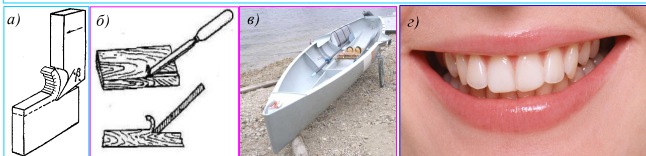
Рис. 50.4. Клин является основой режущих инструментов: а) рабочая часть резца имеет форму клина; б) рабочая часть стамески – тоже клин; в) носовое заострение лодки имеет форму клина, от угла заострения зависит скорость её движения; г) зубы человека имеют форму клина.
