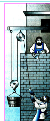
Рис. 17.4. Так можно уменьшить усилие в 2 раза.
