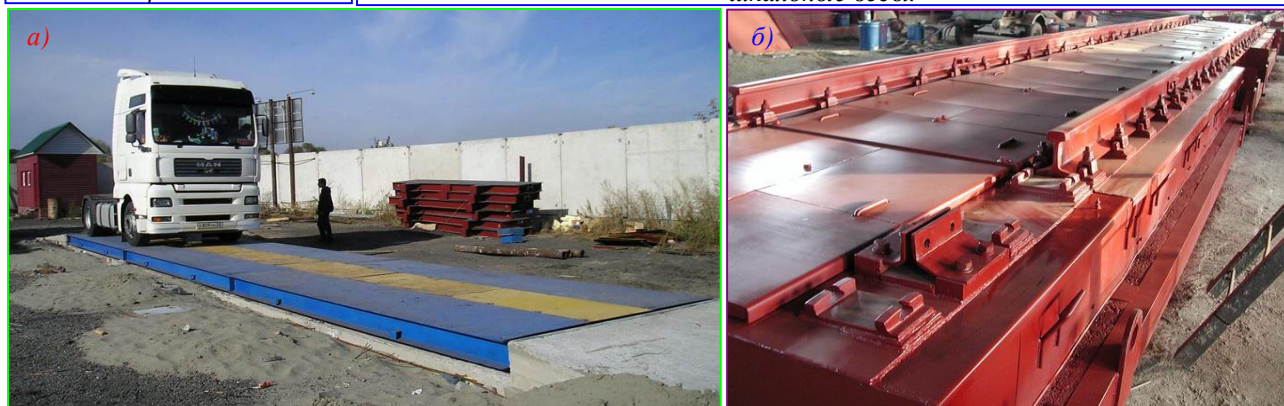
Рис. 26.4. Рычажные весы для взвешивания большегрузных автомобилей (а) и железнодорожных вагонов (б).
