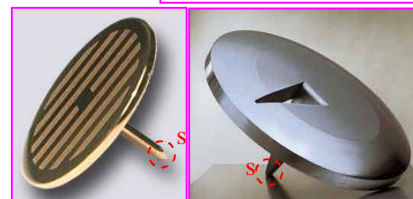
Рис. 3.3. Кнопка, имеющая более острый конец (меньшую s ), легче входит в дерево. У кнопок s \approx 0,03-0,1 \text{ мм}^2 .
