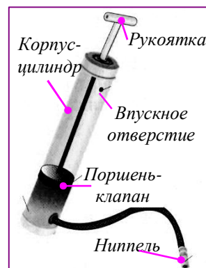
Рис. 1.3п. Устройство велосипедного насоса.
